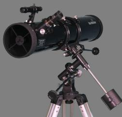
8 Une fois l'axe de DEC remis dans sa position initiale, desserrez l'axe d'AD et vérifiez l'équilibrage de celui-ci. Remontez le contrepoids tout doucement et inclinez l'axe dans un sens ou dans l'autre pour trouver le bon équilibrage. Déplacez le contrepoids sur sa barre afin d'obtenir l'équilibrage optimal. **ATTENTION !!! N'oubliez pas de resserrer l'axe d'AD entre chaque déplacement du contrepoids et gardez toujours votre main sur la barre quand vous desserrez ce frein.**
